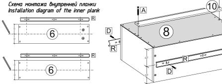
Отметьте середину на боковине ящика и прикрутите внутреннюю планку направляющей строго по отмеченной середине
